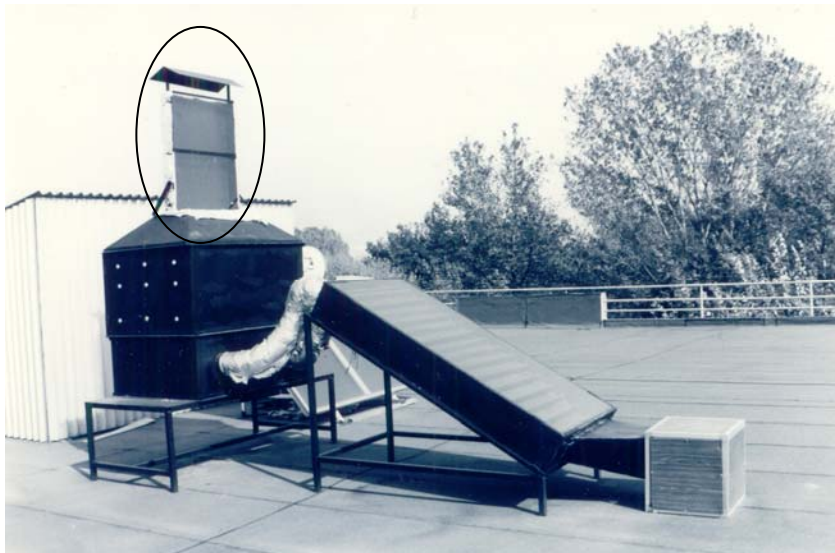
Σχήμα 7. Ηλιακό ξηραντήριο του Τ.Ε.Ι Σερρών με προσαρμοσμένη την ηλιακή καμινάδα στην κορυφή
