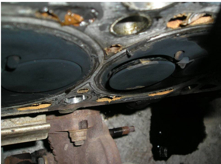
Εικόνα 8-4 Αρχική κατάσταση βαλβίδων και κεφαλής κινητήρα του VW Golf
