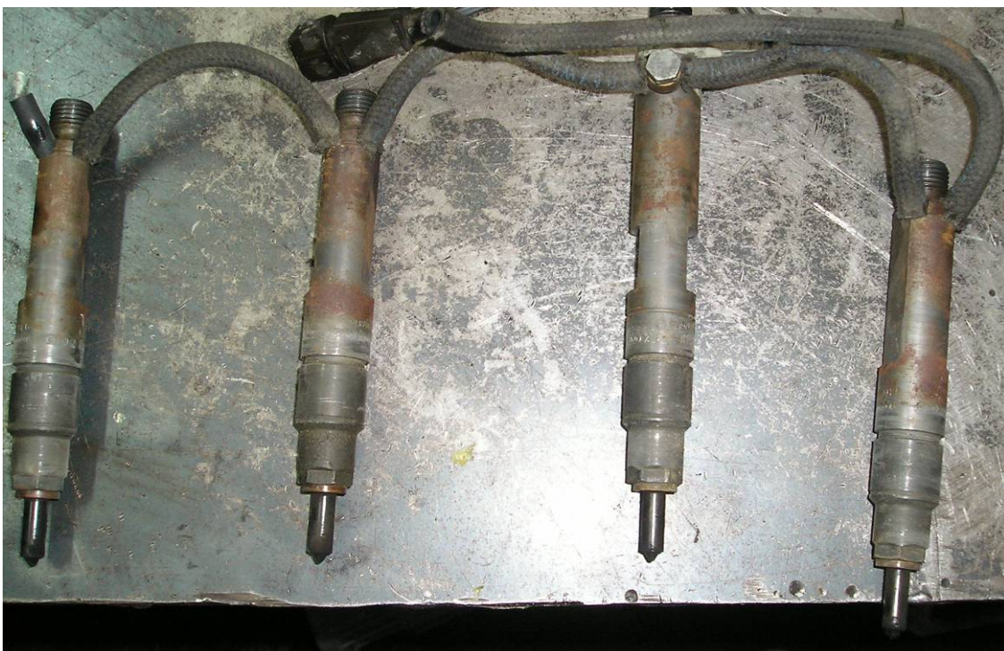
Εικόνα 8-8 Αρχική κατάσταση εγχυτήρων καυσίμου του VW Golf
