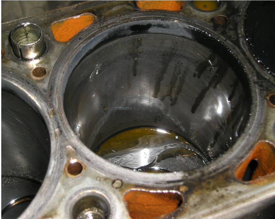
Εικόνα 8-2 Κατάσταση εσωτερικού κυλίνδρου του VW Golf μετά τη χρήση των μιγμάτων βαμβακελαίου - diesel
