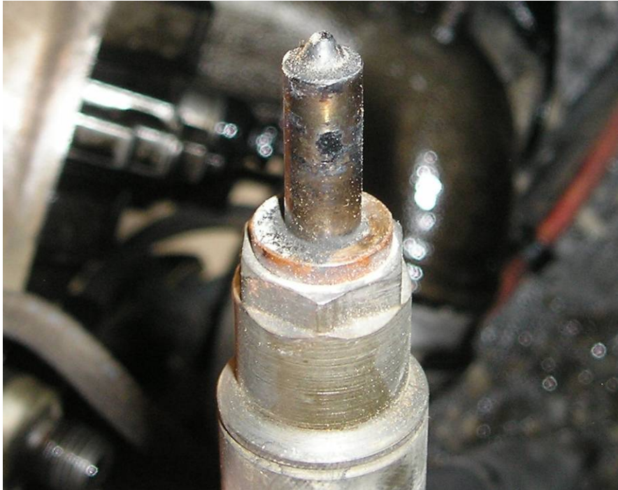
Εικόνα 8-10 Εγχυτήρας καυσίμου VW Golf μετά την εφαρμογή των μιγμάτων βαμβακελαιίου-diesel
