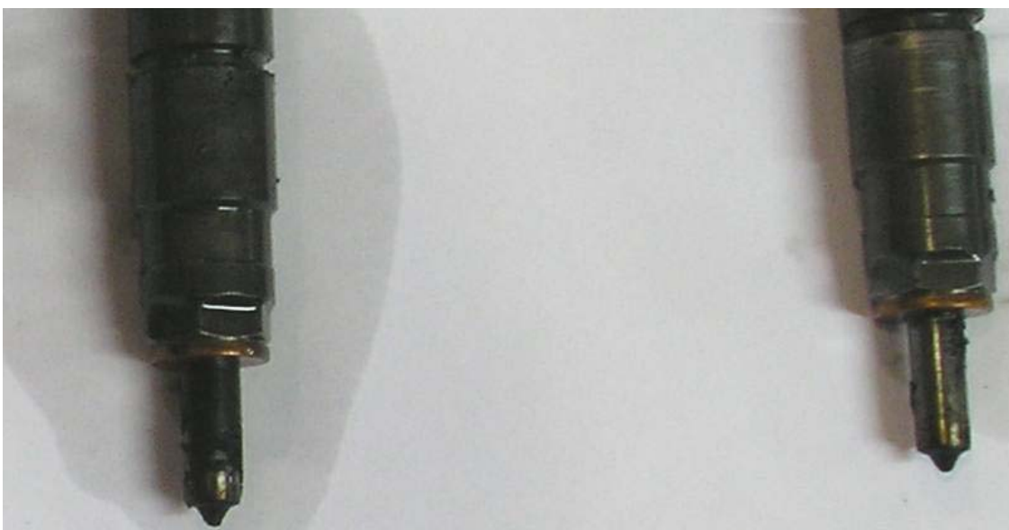
Εικόνα 8-12 Εγχυτήρας καυσίμου Renault Laguna μετά την εφαρμογή των μιγμάτων βαμβακελαίου-diesel
