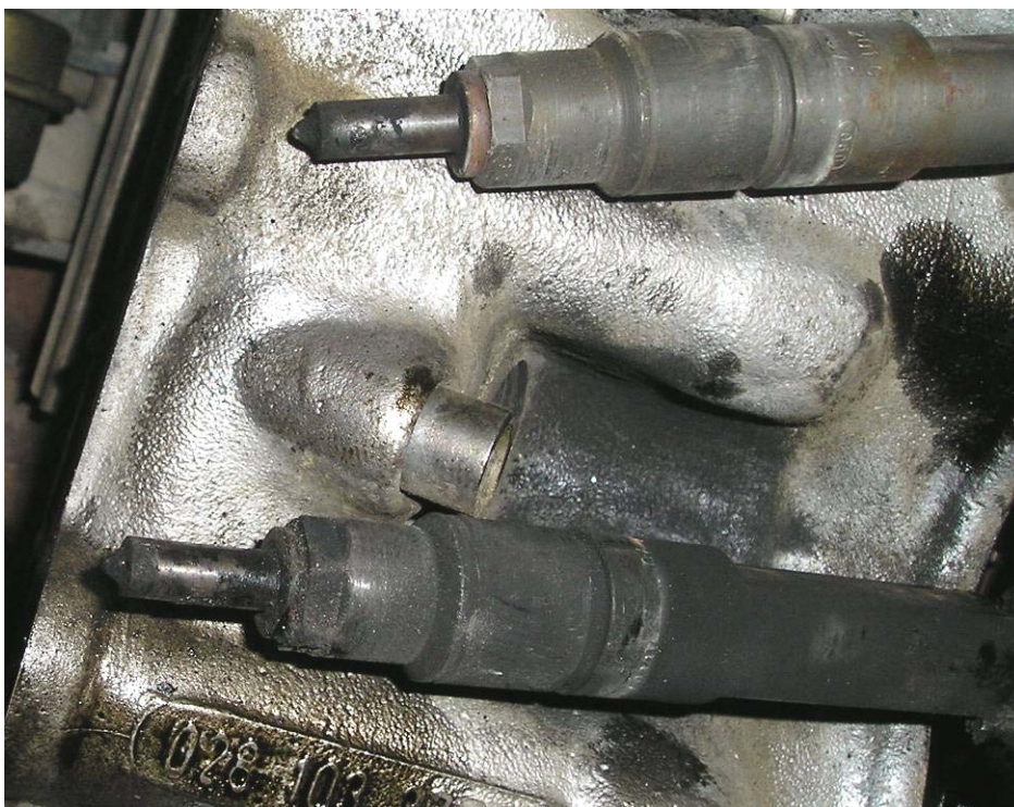
Εικόνα 8-9 Κατάσταση εγχυτήρων καυσίμου του VW Golf μετά τη χρήση των μιγμάτων βαμβακελαίου - diesel
