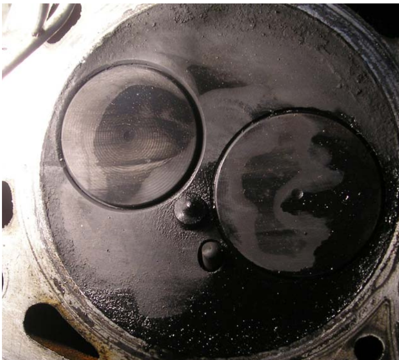
Εικόνα 8-7 Κατάσταση βαλβίδων του VW Golf μετά τη χρήση των μιγμάτων βαμβακελαιου-diesel
