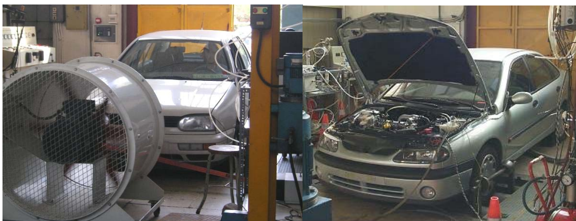
Εικόνα 7-1 Τα πειραματικά οχήματα VW Golf (αριστερά) και Renault Laguna (δεξιά) κατά τη διάρκεια μετρήσεων
