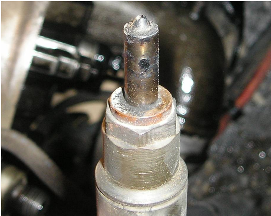
Εικόνα 8-10 Εγχυτήρας καυσίμου VW Golf μετά την εφαρμογή των μιγμάτων βαμβακελαιού-diesel
