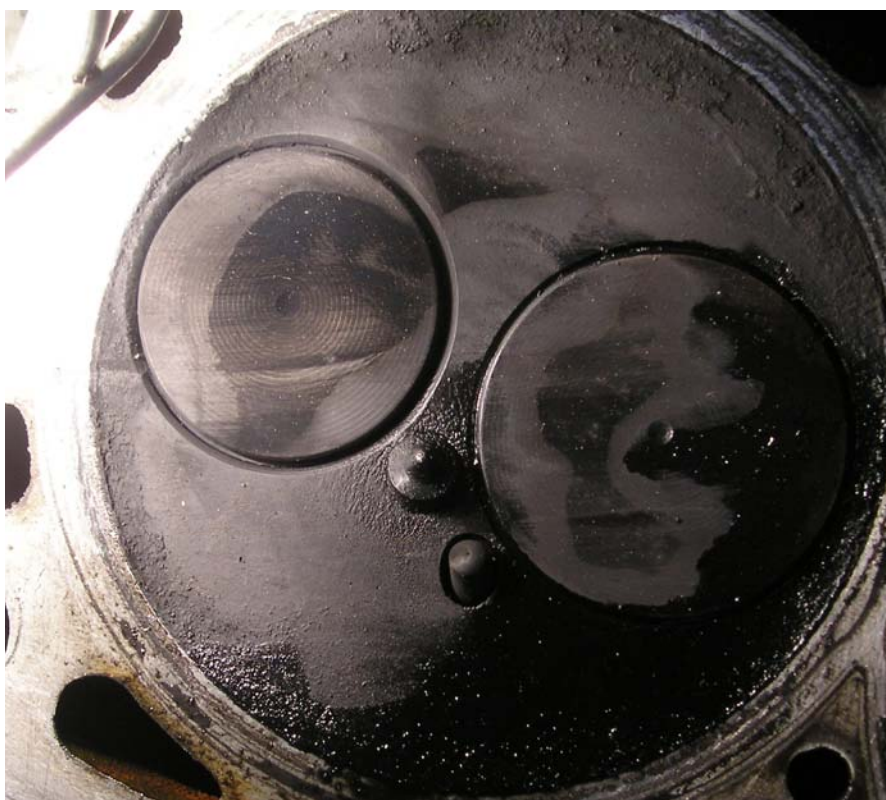
Εικόνα 8-23 Κατάσταση βαλβίδων μετά τη χρήση των μιγμάτων
