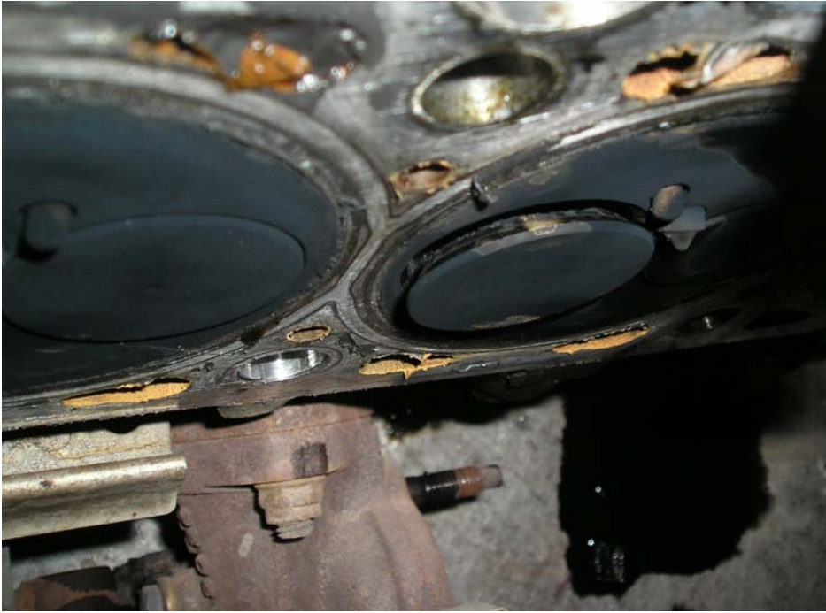
Εικόνα 8-20 Αρχική κατάσταση βαλβίδων και κεφαλής κινητήρα
