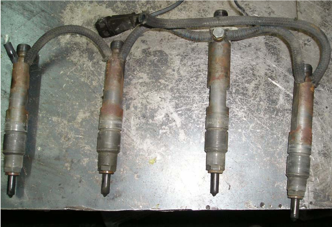
Εικόνα 8-24 Αρχική κατάσταση εγχυτήρων καυσίμου
