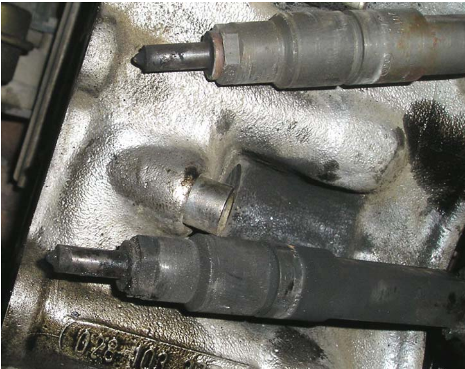
Εικόνα 8-25 Κατάσταση εγχυτήρων καυσίμου μετά τη χρήση των μιγμάτων
