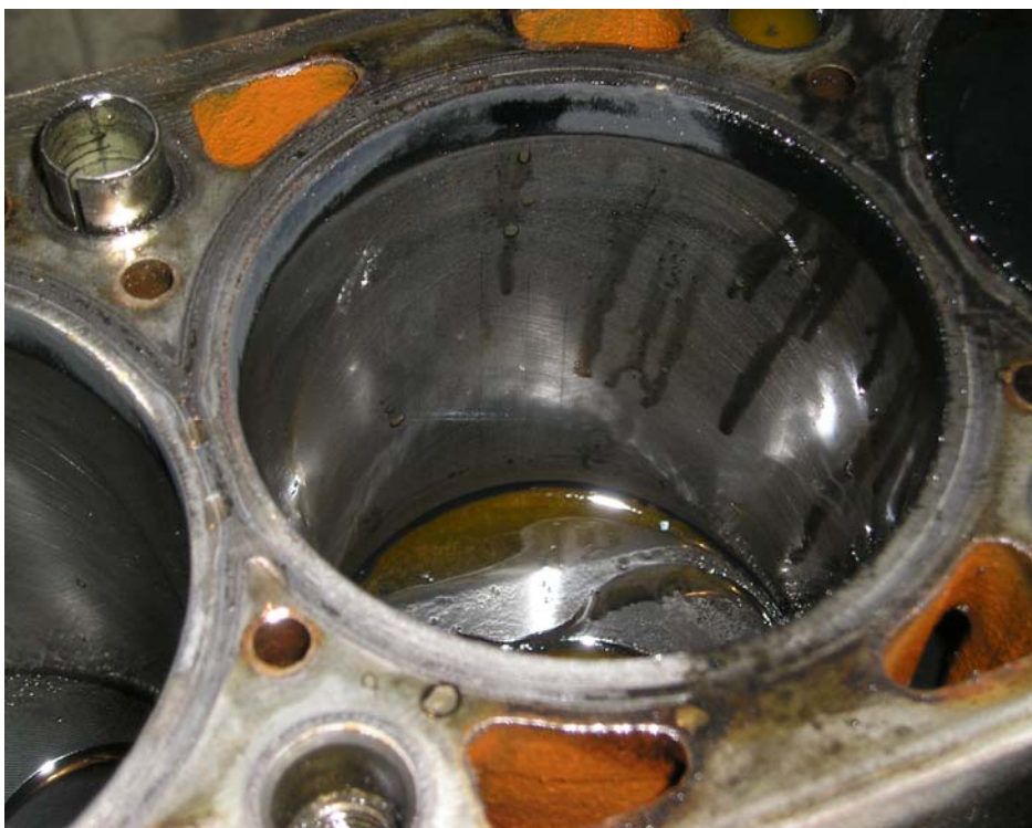
Εικόνα 8-18 Κατάσταση εσωτερικού κυλίνδρου μετά τη χρήση των μιγμάτων
