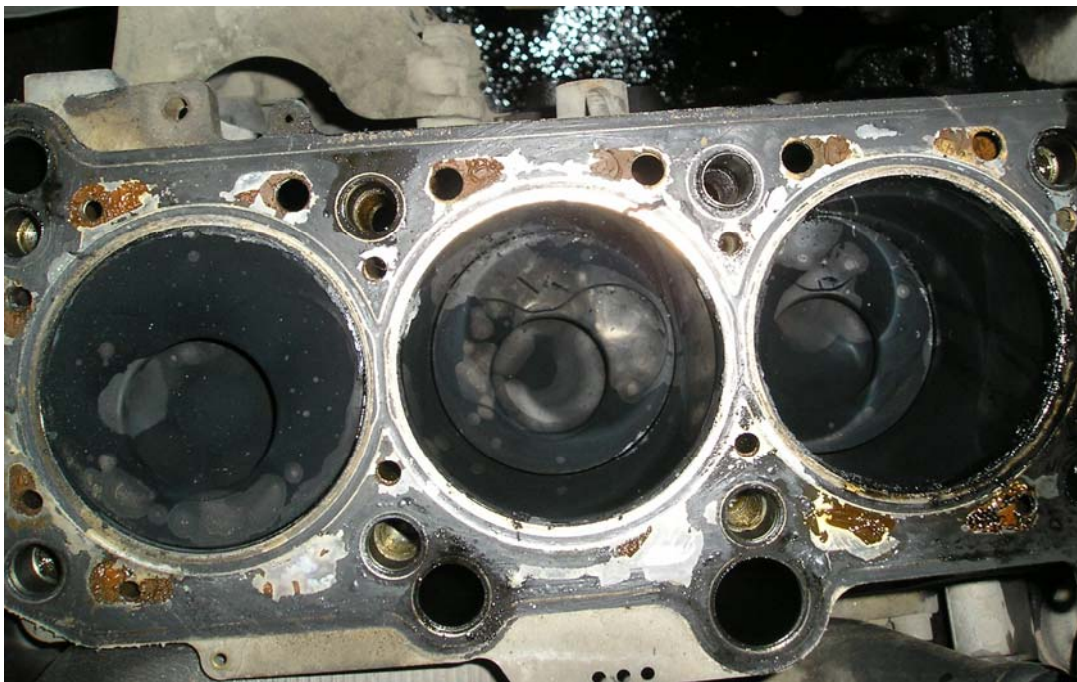
Εικόνα 8-17 Αρχική κατάσταση εσωτερικού κυλίνδρων και κεφαλών εμβόλων
