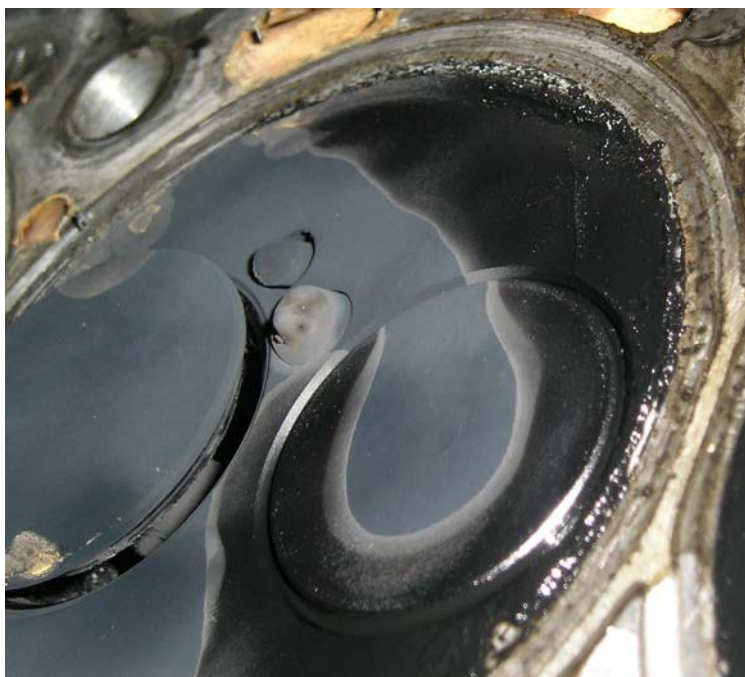
Εικόνα 8-22 Αρχική κατάσταση βαλβίδων και κεφαλής κινητήρα (διακρίνεται ο εγχυτήρας)
