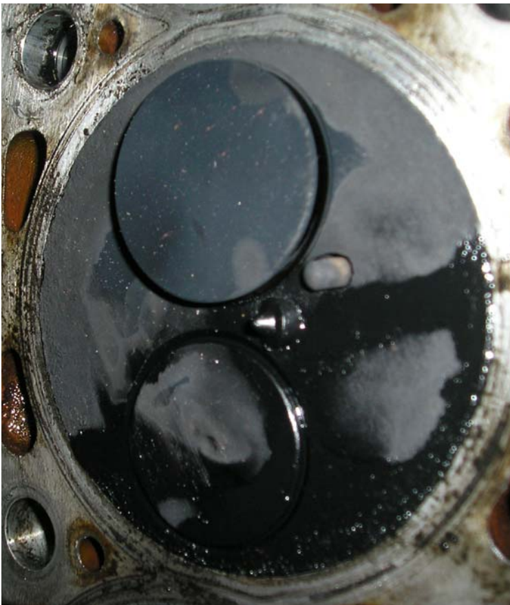
Εικόνα 8-21 Βαλβίδες και κεφαλή μετά την εφαρμογή των μιγμάτων
