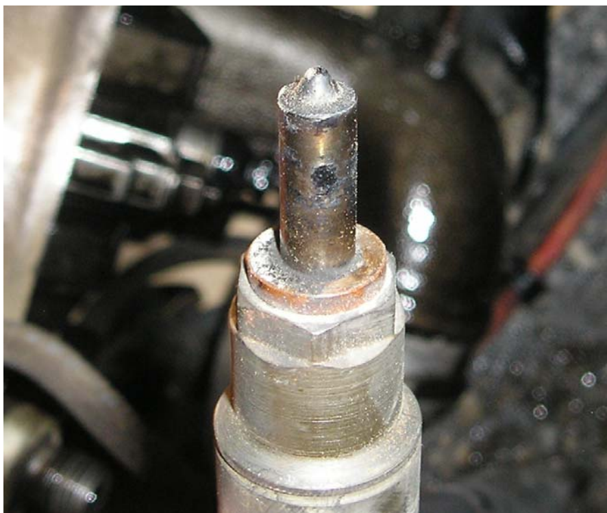
Εικόνα 8-26 Εγχυτήρας καυσίμου μετά την εφαρμογή των μιγμάτων
