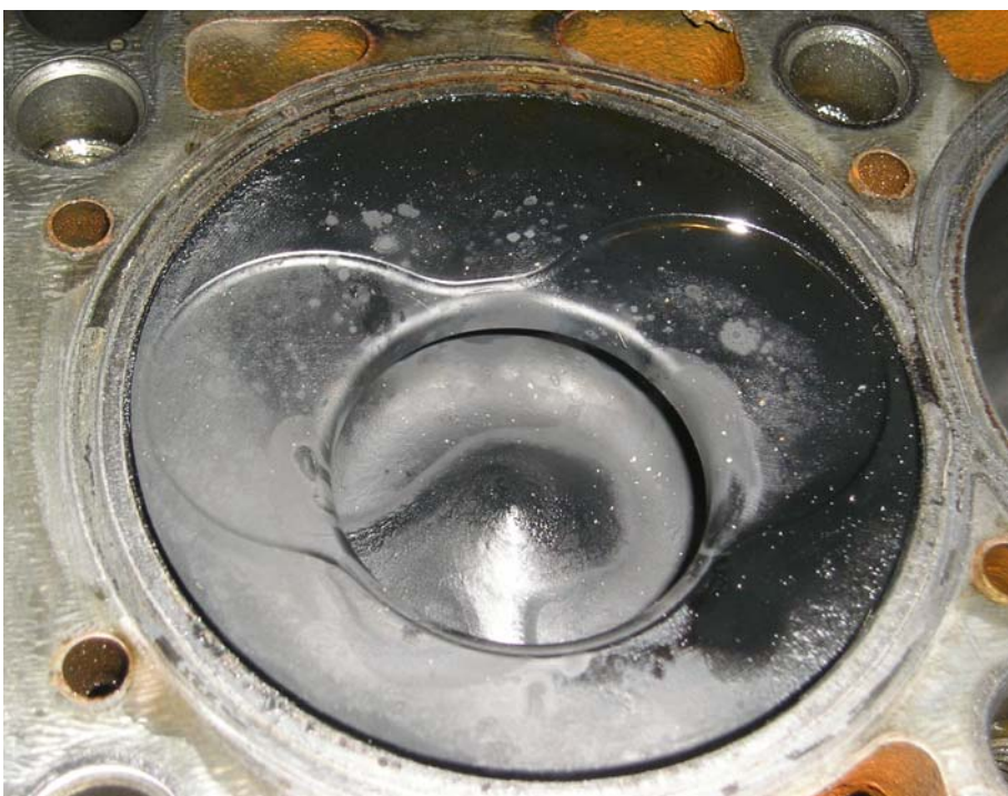
Εικόνα 8-19 Κατάσταση κεφαλής εμβόλου μετά τη χρήση των μιγμάτων
