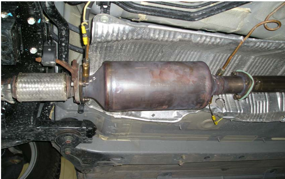
Εικόνα Β. Διαμόρφωση Προκαταλύτης+Φίλτρο σωματιδίων
