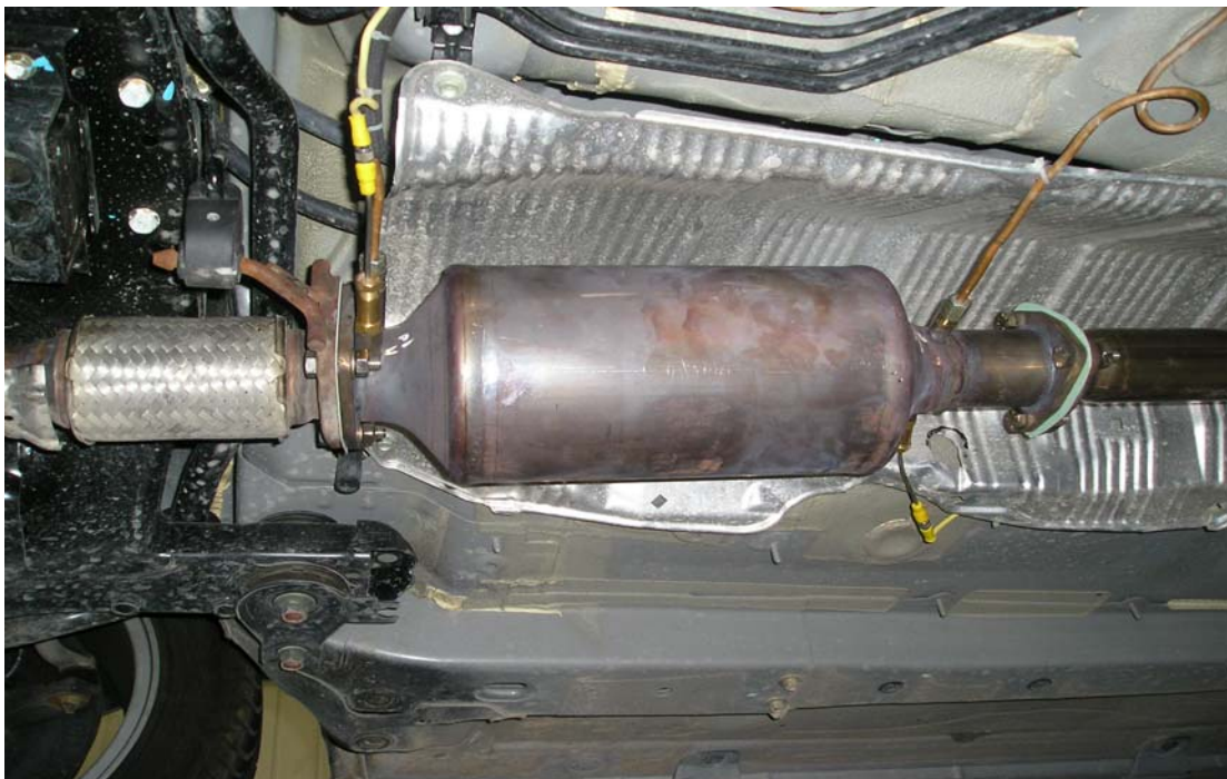
Εικόνα 23. Διαμόρφωση Προκαταλύτης+Φίλτρο σωματιδίων
