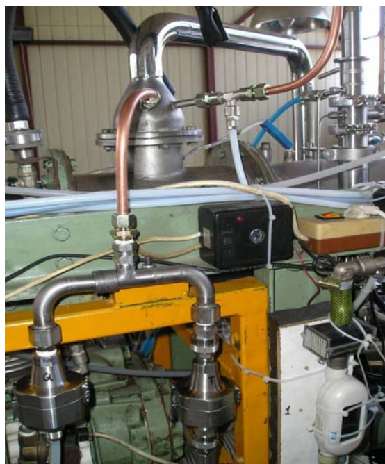
Εικόνα 25. Ακροσωλήνια δειγματοληψίας για φίλτρα 47 mm
