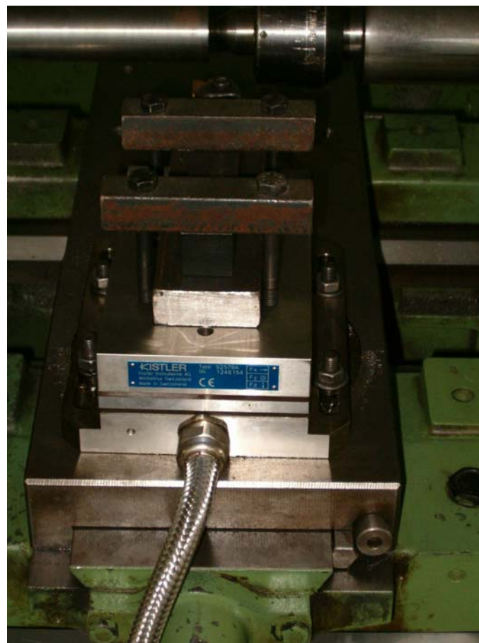
Εικόνα 3: η δυναμομετρική τράπεζα της εταιρείας KISTLER που χρησιμοποιήθηκε για τη μέτρηση των δυνάμεων κοπής.
