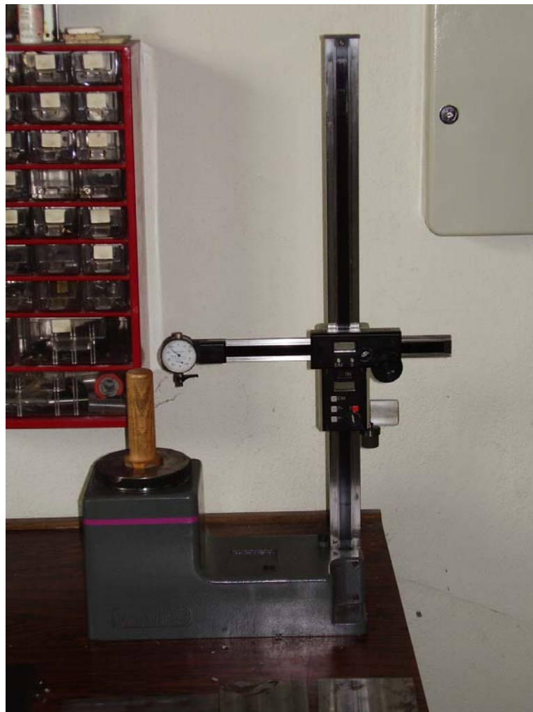
Εικόνα 2 : Συσκευή μέτρησης των διαστάσεων των κοπτικών εργαλείων
