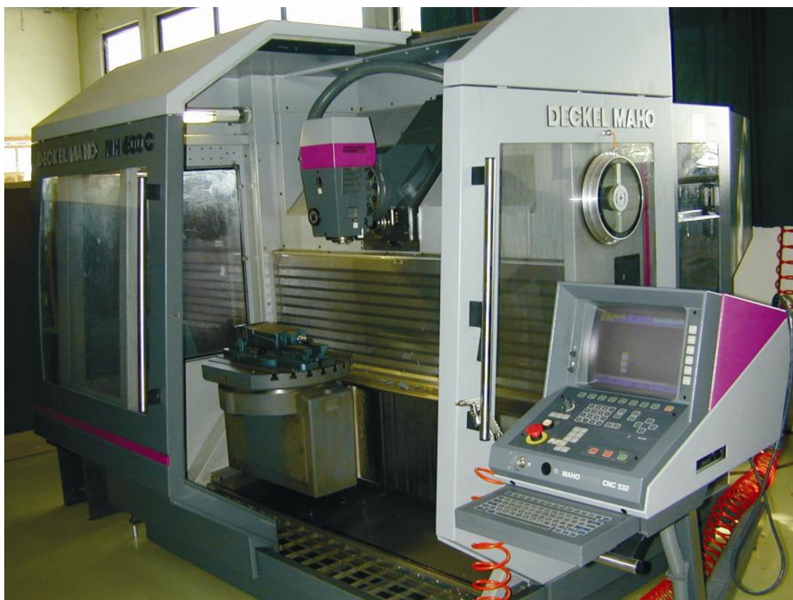
Εικόνα 1: το ψηφιακά καθοδηγούμενο πενταξονικό κέντρο κατεργασίας DECKEL MAHO MH 600 C (Εικόνα 1) του Εργαστηρίου Εργαλειομηχανών του Τμήματος Μηχανολογίας του Τ.Ε.Ι. Σερρών.
