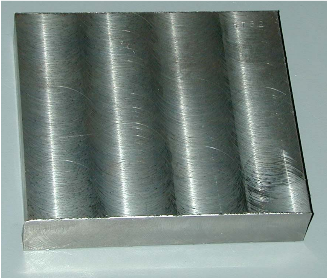
Σχήμα 4: κοινός χάλυβας κατασκευών St52-3
