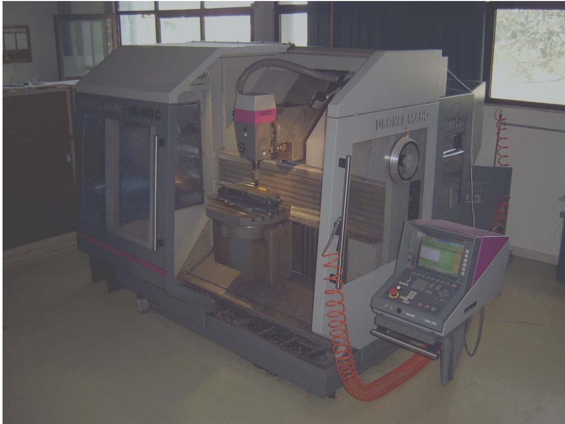
Εικόνα 1: Η ψηφιακά καθοδηγούμενη φραιζομηχανή DECKEL MAHO MH 600C του Εργαστηρίου Εργαλειομηχανών του Τ.Ε.Ι. Σερρών.
