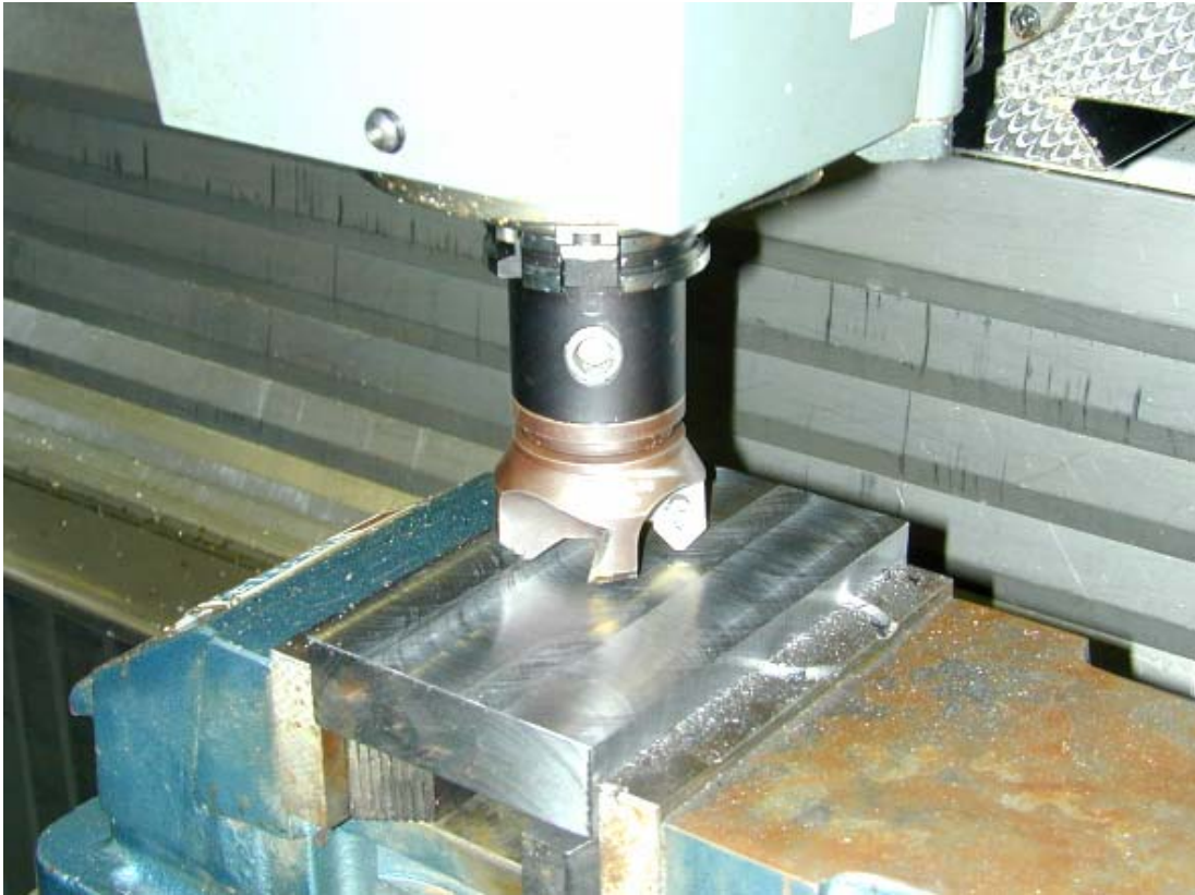
Εικόνα 5: Κατεργασία εκχόνδρισης δοκιμίου.
